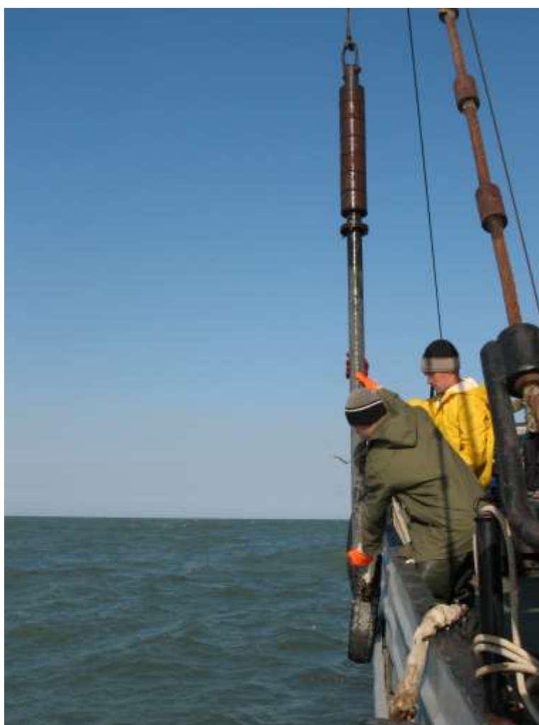
отбор проб донных отложений (на фото Аксёнов Д.С., Польшин В.В.)
